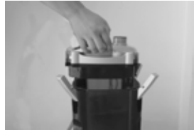
3. Возьмитесь за ручки с обеих сторон, нажмите на «голову» фильтра, потяните ее и выпаттите. Снимите с верхней корзины разделительную решетку и выньте корзины, после этого можно приступить к промывке фильтрующих материалов.
